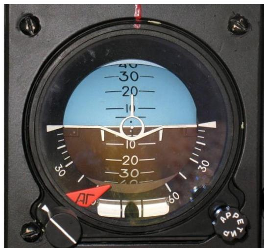
*Прибор «Авиагоризонт» устанавливается на каждом самолете и находится в кабине экипажа*
